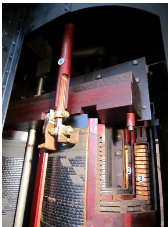
Рисунок 8.3 – Генераторный трансформатор 8/50 кВ, 6000 кВА производства Brown, Boveri & C ie
