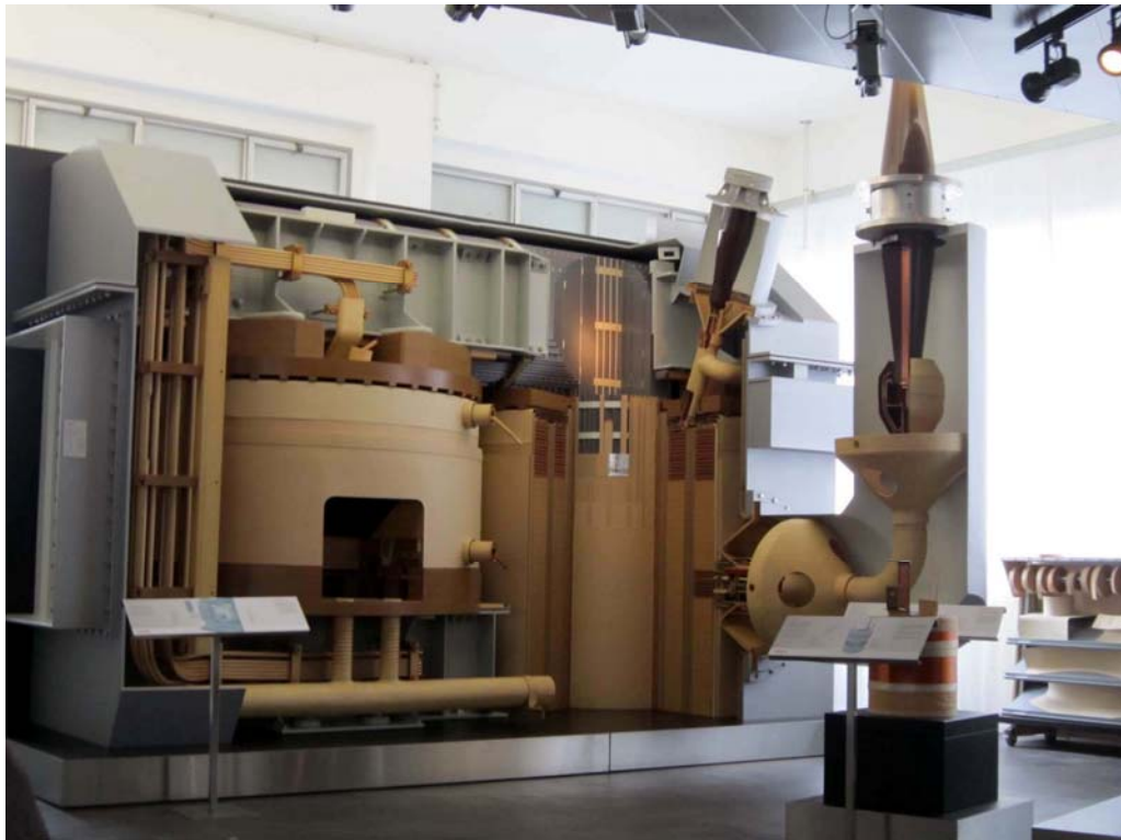
Рисунок 8.1 – Масштабная модель внутренней изоляции силового трансформатора, отражающая спектр продукции компании Weidmann
