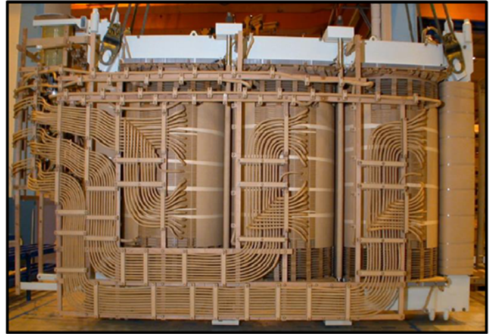
Рисунок 3.2 – Активная часть УШР 50-100 Мвар, 242 кВ
