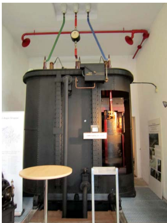
Рисунок 8.3 – Генераторный трансформатор 8/50 кВ, 6000 кВА производства Brown, Boveri & C ie
