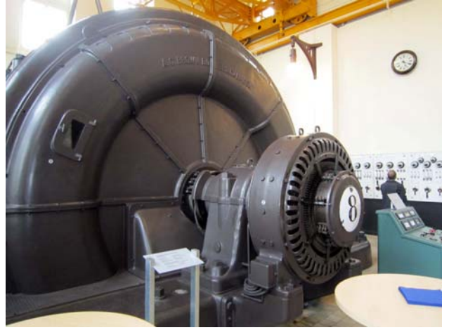
Рисунок 8.4 – Ковшовая гидротурбина 1918 г. выпуска производства Theodor Bell & C ie ( a ) и генератор 12000 кВт, 8 – 8,5 кВ производства Brown, Boveri & C ie ( б )
